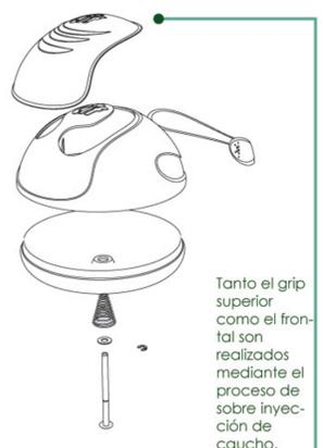
Tanto el grip superior como el frontal son realizados mediante el proceso de sobre inyección de caucho.
