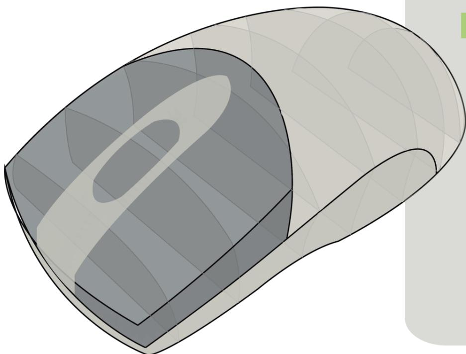
■ Por último se **SUSTRAE** parte de la última forma agregada y se la reemplaza por una basada en la misma idea de elipse, con una pequeña sustracción, que permitirá el uso de la rueda.
