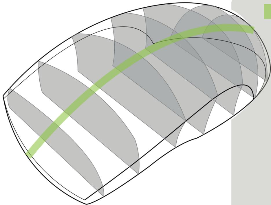
■ La forma del mouse está generada a partir de una **DIRECTRIZ** y **GENERATRICES** Y mediante la sustracción y adición de otras formas.
