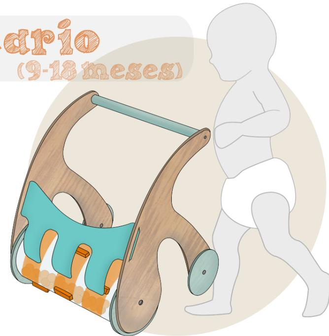
El sonido se genera debido al movimiento de las **paletas** al accionar el caminador, identificando que el usuario está interactuando con él.
