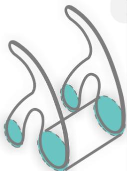
La morfología de los laterales se genera por la adaptación de los mismo a las ruedas delanteras y traseras regulando su amplitud según las mismas.
