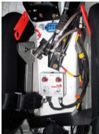
El repartidor de frenada permite ajustar los parámetros para adaptarlos al tipo de conducción requerida.
