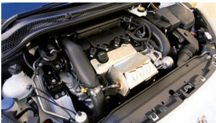
Con 270 CV, este 4 cilindros es uno de los 1.6 con mayor potencia específica del mercado.
