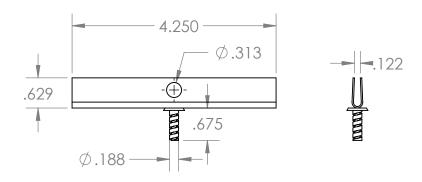
TOPPER HAS A SCREW WELDED TO BOTTOM CENTER
