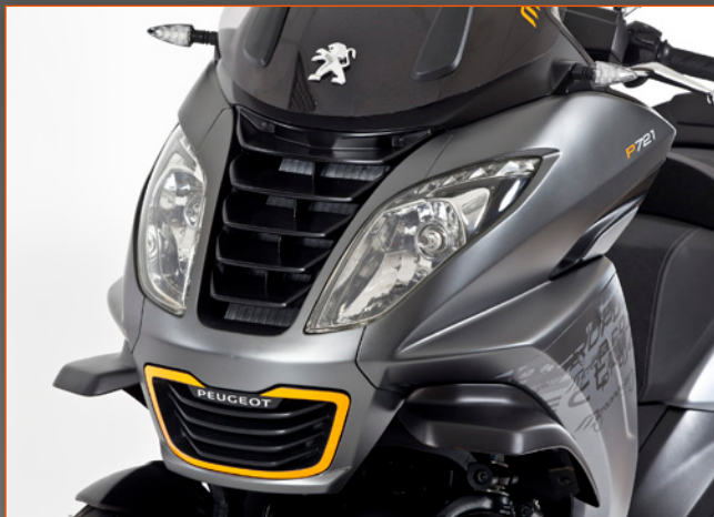
Double optique entre lesquels prend place le radiateur du refroidissement moteur et une calandre qui n'est pas s'en rappeler celle des automobiles de la marque.
