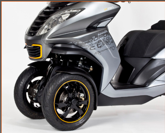
Le train avant du Metropolis et ses deux roues de 12" équipées chacune d'un disque Ø200mm avec étriers flottants.
