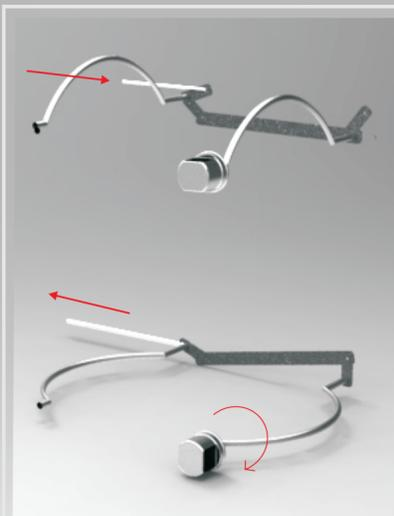
El mecanismo de fijación, unido al de los sujetadores, trabajan solidarios. al poner en funcionamiento el mecanismo de los sujetadores, el mismo empuja un eje que traba el movimiento del anafe cuando estos no se usan, y en caso inverso cuando estos son utilizados, de este modo se asegura que el anafe este destrabado cuando se utilice con el velero en movimiento.
