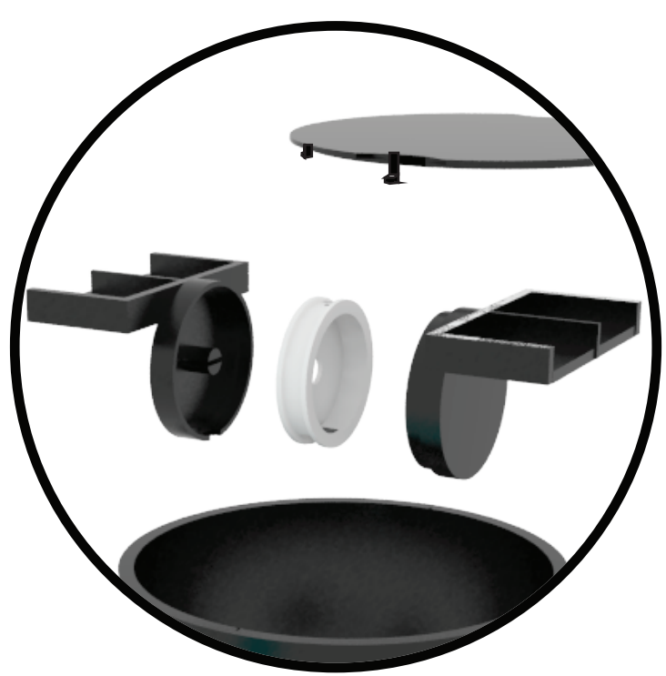
Compartimiento de imanes y mecanismo retráctil.
