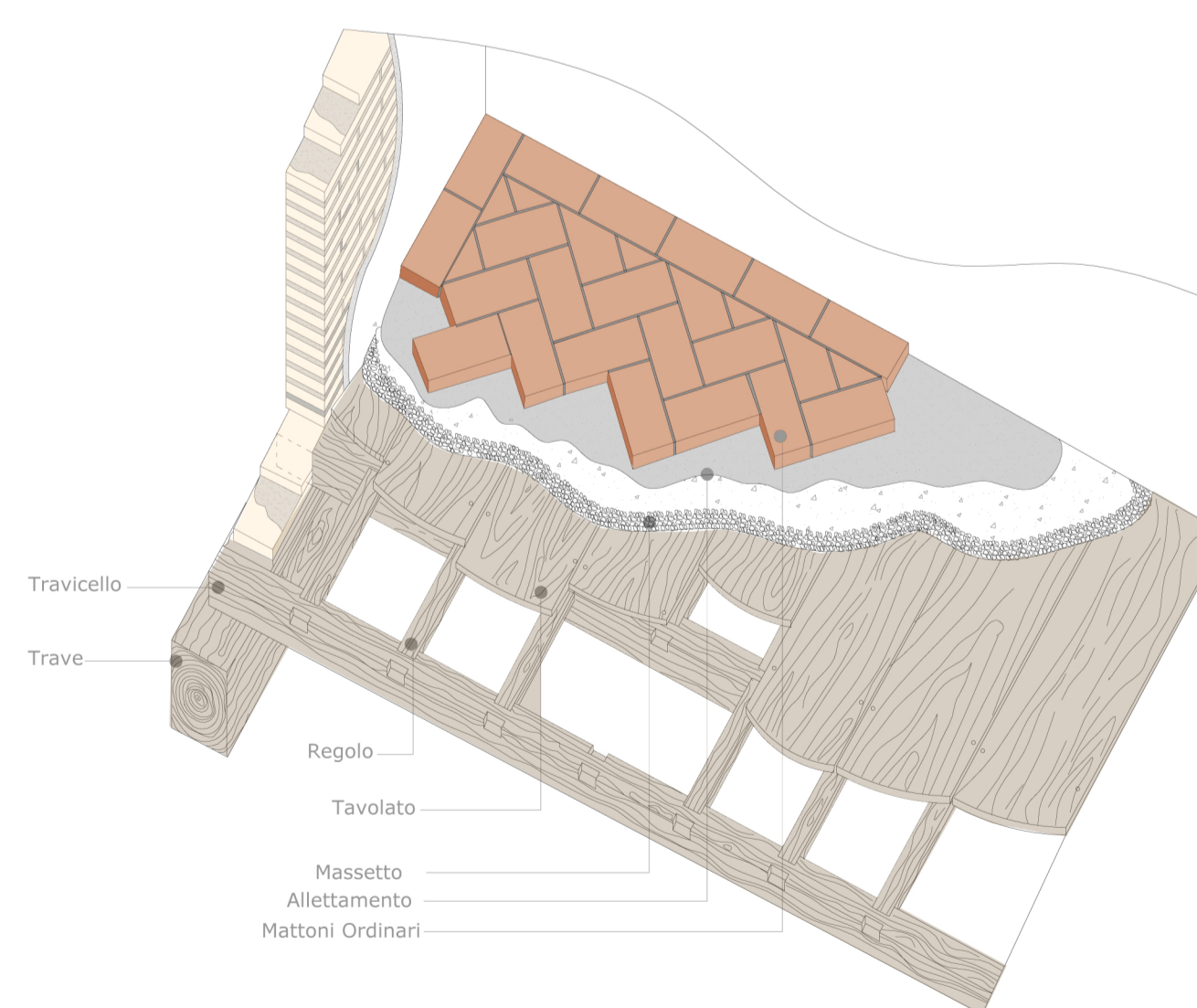
DETTAGLIO SOLAIO PRE-MODERNO CON REGOLO
