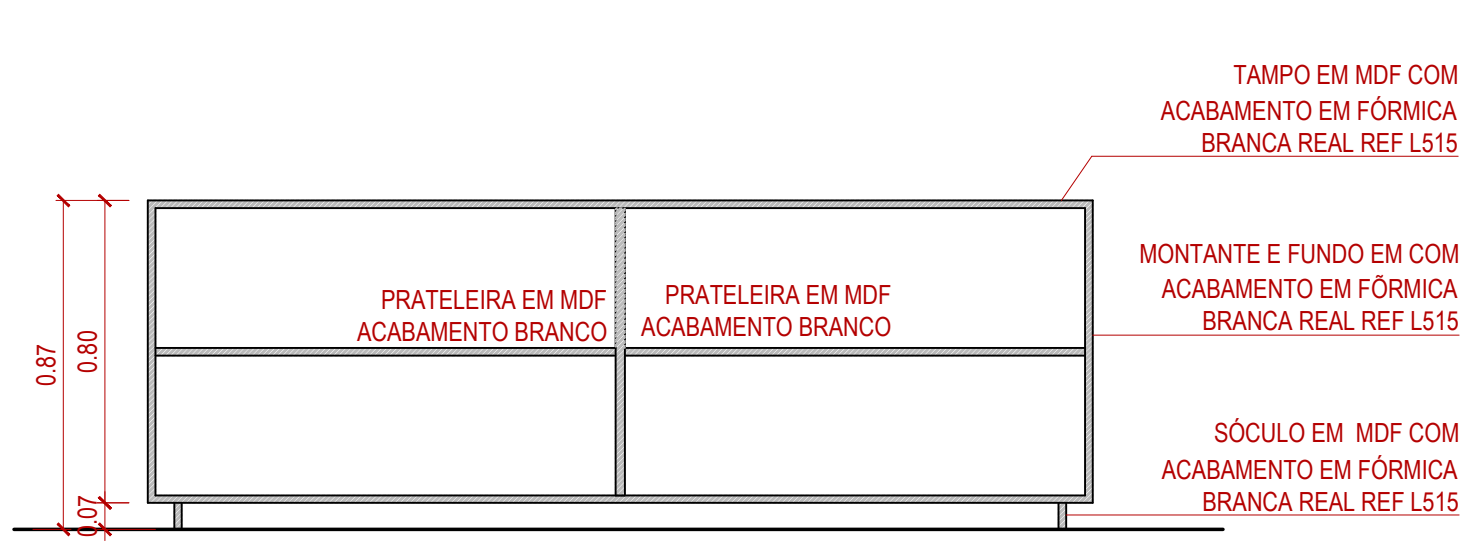
3 CORTE TRANSVERSAL MB13 - BALCÃO BENVIVERE - TREINAMENTO ESCALA 1:20
