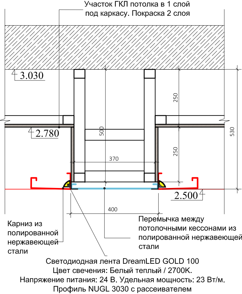
Разрез потолка 2-2
